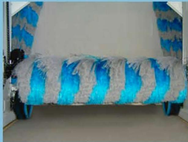
El cepillo horizontal es controlado por un sistema electrónico amperométrico, el cual garantiza la máxima fiabilidad. Su presión es constante sobre toda la superficie del vehículo en una manera fluida, también a velocidad alta de trabajo.
