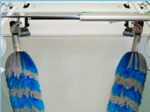
El sistema oscilante de los cepillos verticales, montado en un carro y regulado por un cilindro neumático que garantiza la adherencia, le permite trabajar de manera uniforme sobre toda la superficie lateral del vehículo, ya que el apoyo está garantizado únicamente por su peso. De esta manera se puede obtener tener la más alta velocidad en los movimientos del puente.
