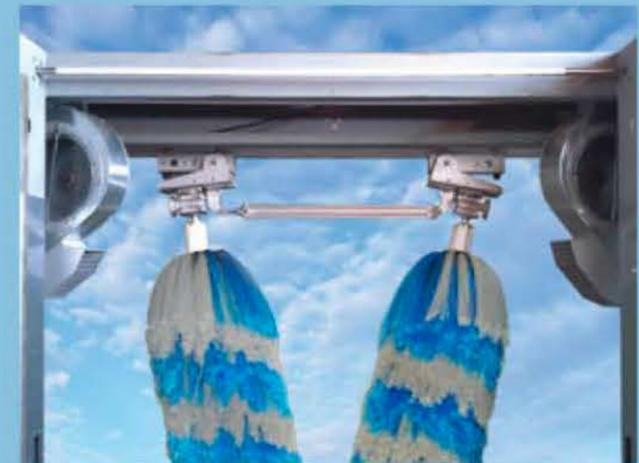
El tipo de secado en dos ventiladores opuestos, neumáticamente operado tanto vertical como horizontalmente, con el fin de conducir el aire en la dirección de desplazamiento, debido a su potencia ( 4 Kw cada uno ), garantiza un excelente resultado final.
