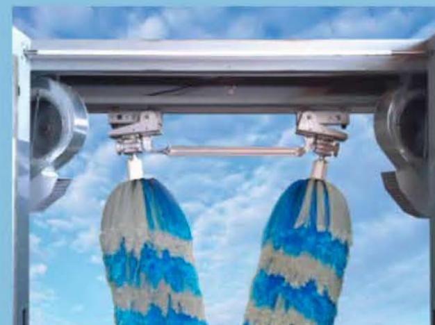
Il tipo di asciugatura a due ventilatori contrapposti, azionati pneumaticamente sia in verticale che in orizzontale in modo da convogliare l'aria nel senso di marcia, grazie anche alla loro potenza (4 Kw cadauno), garantiscono un'ottimo risultato finale. Inoltre, il semplice sistema di movimentazione, permette di poter lavorare anche a velocità sostenute.
