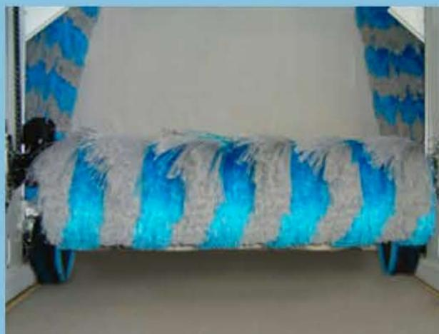
La spazzola orizzontale è controllata da un sistema amperometrico elettronico, che ne garantisce la massima affidabilità. La sua pressione è costante su tutta la superficie del veicolo, in modo fluido, anche a velocità di lavoro sostenute.
