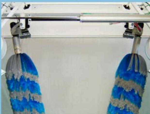
Il sistema oscillante delle spazzole verticali, montate su carrelli, e regolate da un cilindro pneumatico che ne garantisce l'aderenza, permette loro di lavorare in modo uniforme su tutta la superficie laterale del veicolo, in quanto l'appoggio è garantito su qualsiasi sagoma. In questo modo si può avere la massima velocità, di movimento, del portale.
